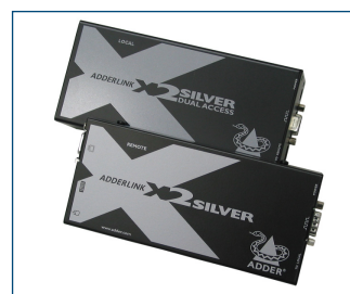
Der optionale KVM-Extender ermöglicht es, den Monitor bis zu 300m entfernt vom Computer zu platzieren.
